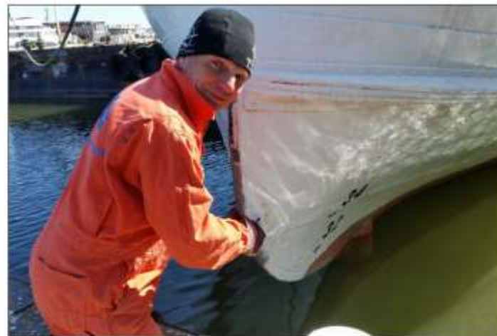
Per Ahlqvist på målarflotten i Gøtenius varusbasäng vid Bosvass, en skarpa akterstäv 20 april 2020. Nu ska vitfärgen kompletteras efter rostsanering. Foto Gunnar Söderberg.
